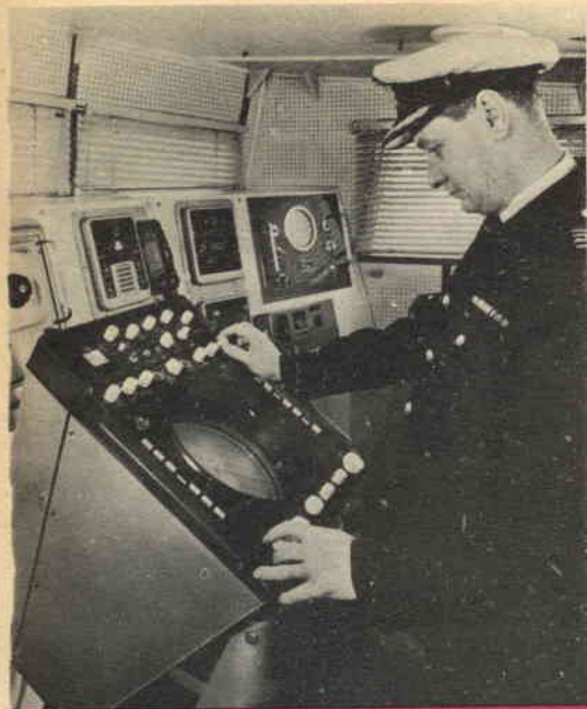
Unità di presentazione del radar a transistori Raymarc 12, installato nel salone di dimostrazione del battello di ricerca Elettra III della Marconi.
